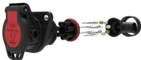
Bei dieser Variante wurde eine neue Abschlusskappe integriert, die einen um 360 Grad frei drehbaren Ausgang hat. Des Weiteren überzeuge die Steckdose durch ihre geringe Baugröße (70 Millimeter bei 90 Grad Abgang) für alle Einbausituationen. Außerdem verfügt sie über Bandwarenkontakte für den automatischen Crimp-Prozess. Das Steckdosengehäuse mutet durch Glasfaserverstärkung robust an.
